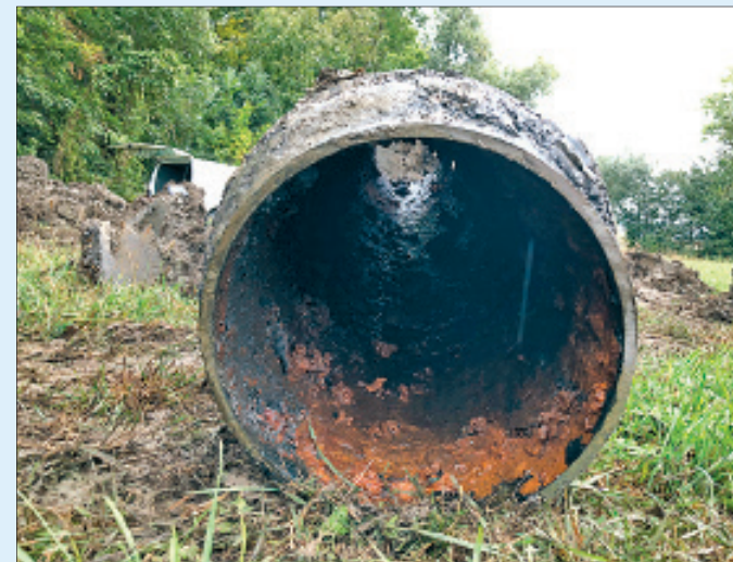
Es dauerte den ganzen Tag, ehe diese beschädigte Rohrleitung aus den 1960er Jahren entfernt und durch eine neue ersetzt war.
